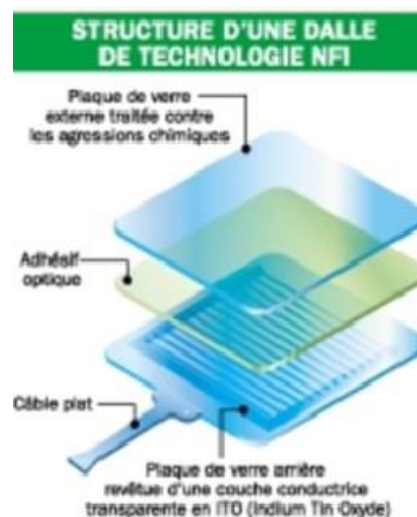
Figure 7: Structure d'une dalle de technologie NFI
